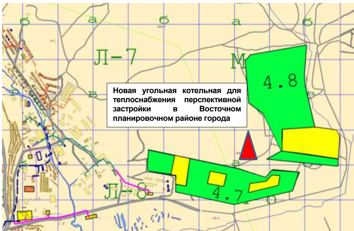
Рисунок 11.2. – Теплоснабжение зоны перспективной застройки 4.7 и 4.8 от новой угольной котельной
